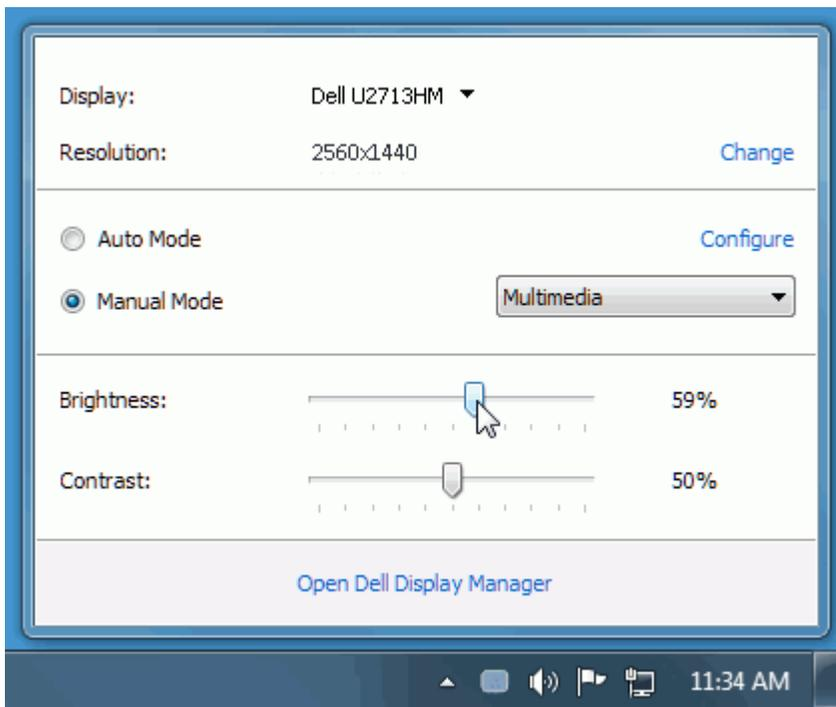
El cuadro de diálogo de configuración rápida también ofrece acceso a la interfaz avanzada de usuario de Dell Display Manager, la cual se utiliza para ajustar funciones básicas, configurar el Modo automático y acceder a otras funciones.
